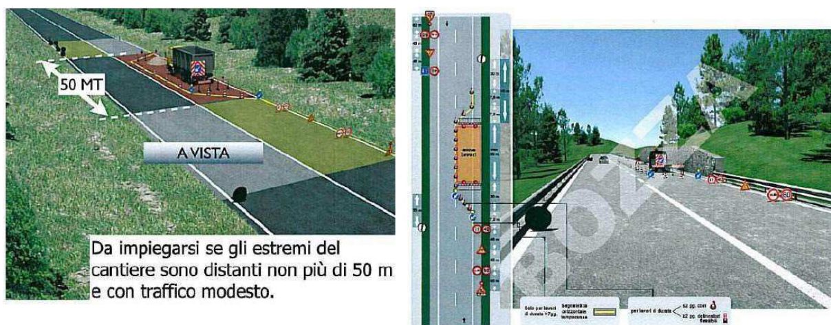
Esempio di cantiere con traffico alternato a vista
