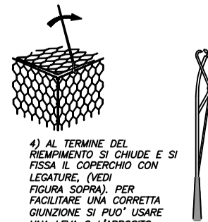
GABBIONE AL TERMINE DELLA POSA DEI TIRANTI
